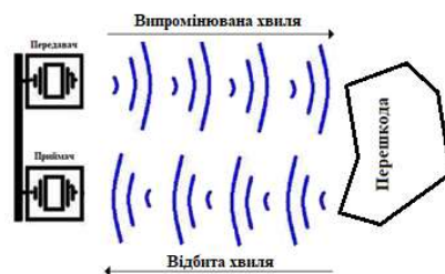
Рисунок 1 – Принцип роботи пристрою акустичної дії
