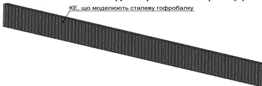
Рис. 1. Кінцево-елементна схема сталеві гофробалки
