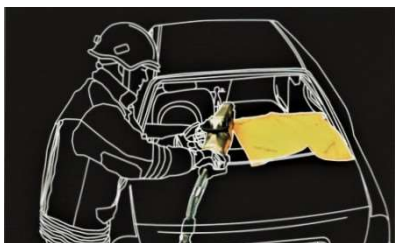
Встановити розтискач по середині, між задньою полицею і дахом автомобіля;
