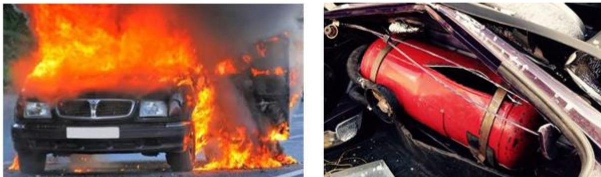
*Рис. 1 – Наслідки вибухів газобалонного обладнання*
