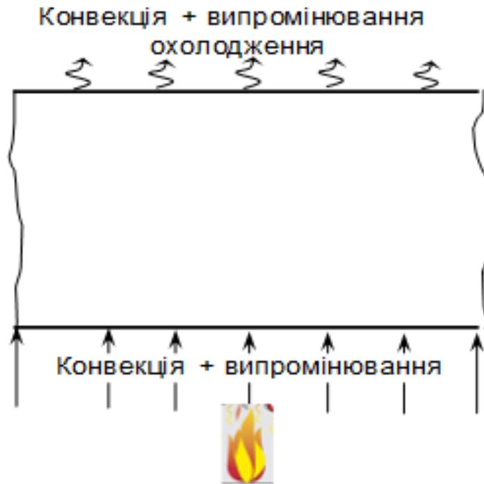
Рис. 1 – Розрахункова схема до теплового розрахунку залізобетонних плит
