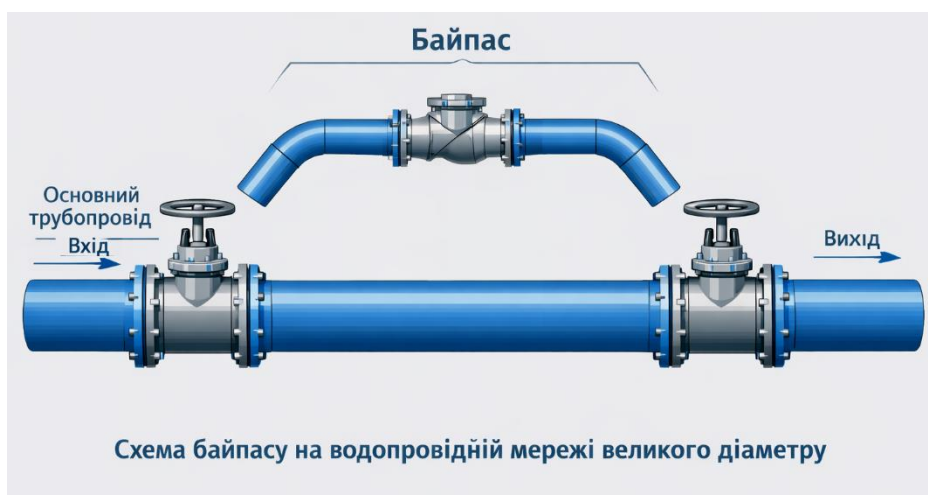
Рисунок 2 – Технологічна схема влаштування байпасу для пожежного гідранту на водопровідній мережі великого діаметру за [3]
