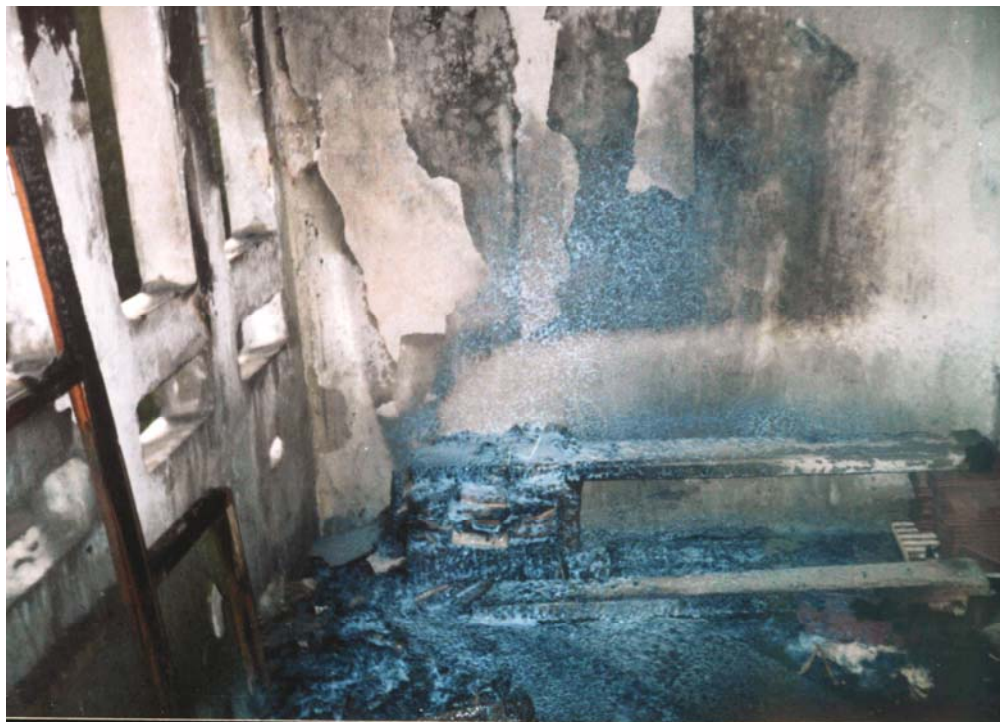
Рис. 2 – Зовнішній вигляд поверхонь, оброблених ГУС \text{Na}_2\text{O} \cdot 2,95\text{SiO}_2 - 3,8\% , \text{CaCl}_2 - 11,4\% після припинення горіння
