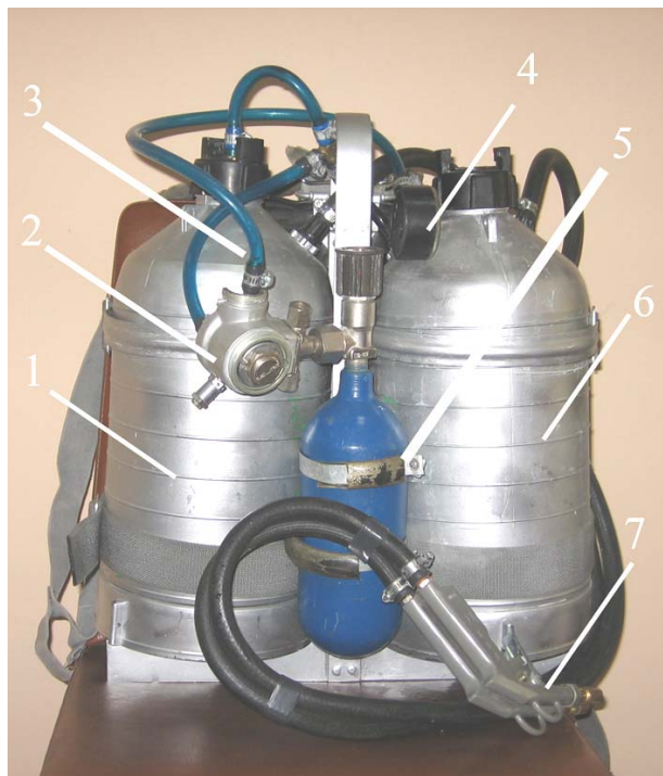
Рис. 1 – Зовнішній вигляд автономної установки гасіння гелеутворюючими складами: 1 – балон з водним розчином гелеутворювача; 2 – редуктор; 3 – система гнучких шлангів; 4 – манометр низького тиску; 5 – балон зі стисненим повітрям; 6 – балон з водним розчином коагулятору; 7 – стволи з пістолетними рукоятками
