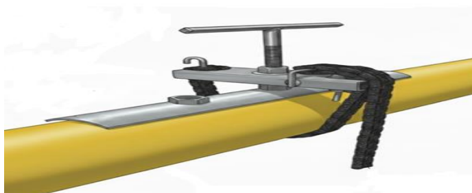
Рис. 1. Гвинтовий бандаж для ліквідації витоків НХР
