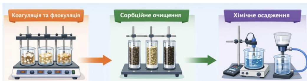
Рис. 1. Багатоступеневий процес очищення радіоактивної води
