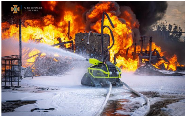
Рис. 1. Застосування БпНРК «Alpha Wolf» у гасінні пожежі в м. Бориспіль
