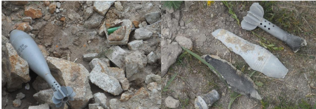
Рис. 1. Результати часткового знищення ВНП із використанням кумулятивних зарядів малої потужності
