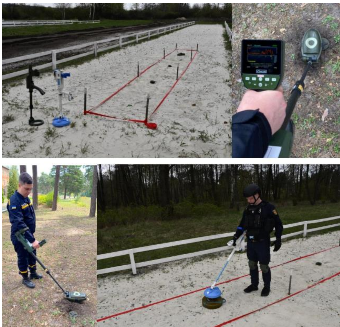
Рис. 4.9. Експериментальна перевірка працездатності методу електромагнітного детектування
