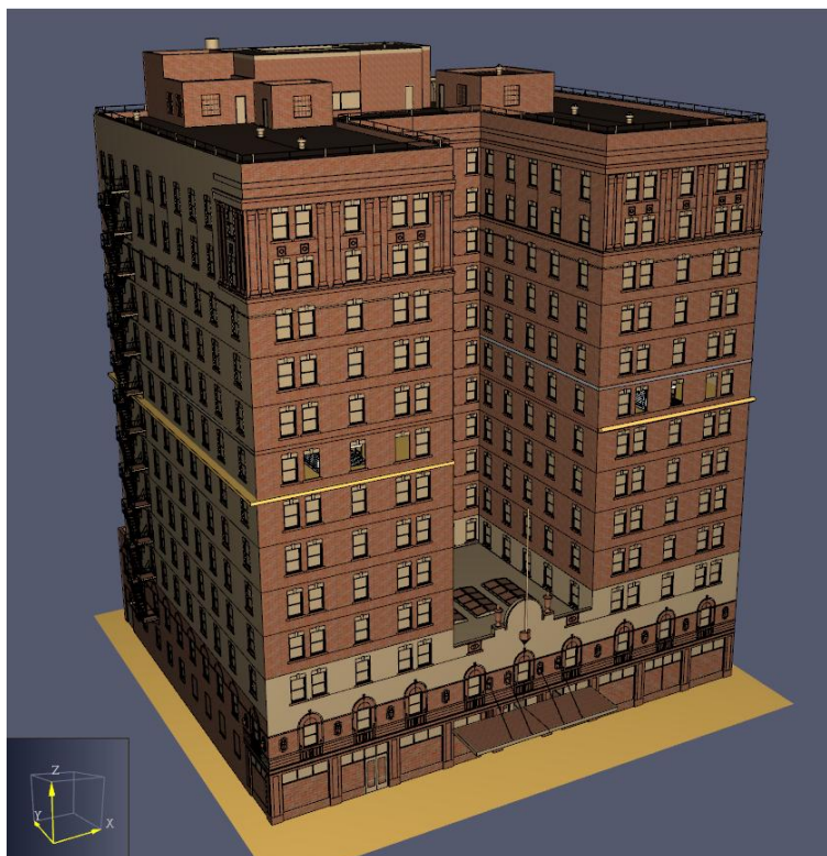
Рисунок 4.13 – Модель будівлі, для оцінювання ефективності протипожежних перешкод за параметричним методом.
