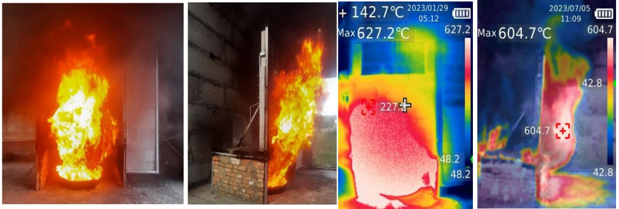
Рисунок 4.5 – Фото фрагменту досліджування поширення пожежі по фасаді, що не обладнаний протипожежним карнизом, а також зафіксовані температурні розподіли.
