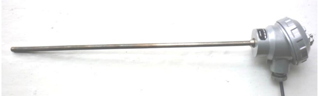
Рисунок 2.4 – Термопара ТХА-VIII – 1-27-К-2-И-320-INC-6-А-(0...1100)°С.
