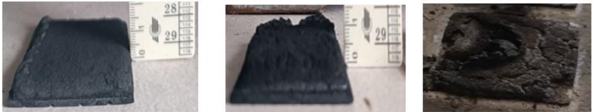
Рис. 4.5 Характер і ступінь спучування сформованого спученого шару в залежності від компонентів реактивної системи: ПФА (а), ПЕ (б) та Al(OH)_3 (в)
