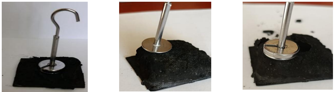
Рис.4.6 Результати експериментального визначення критичного навантаження сформованого спученого шару із застосуванням стандартизованих щілинних вантажів для індивідуальних компонентів реактивної системи: ПФА (а), ПЕ (б) та Al(OH)_3 (в).
