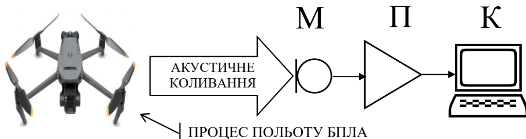
Рисунок 3.42 – Схема лабораторної установки для аналізу АЧХ акустичних коливань процесу польоту різних типів БПЛА: М – мікрофон; П – підсилювач; К – комп'ютер із відповідним програмним забезпеченням
