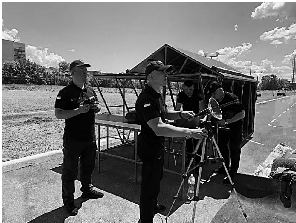
Рисунок 3.43 – Фото, зроблене під час проведення експерименту щодо дослідження можливостей спектрального аналізу акустичного простору щодо виявлення та ідентифікації джерел НС, пов'язаних із застосуванням БПЛА
