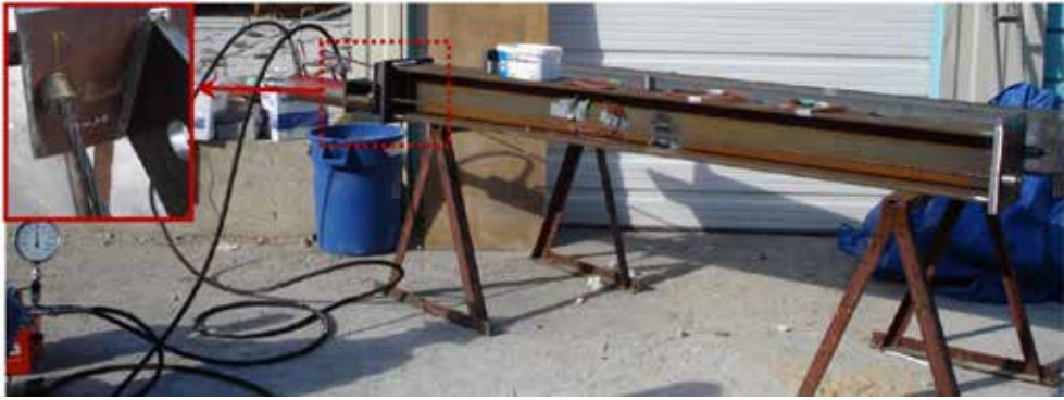
Рис. 1. Система попереднього напруження для задавання осевого навантаження
