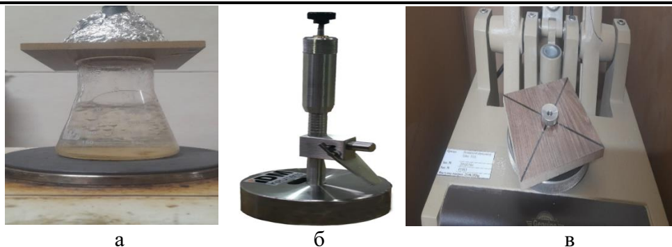
Рисунок 2 – Дослідження впливу декоративного паперу (оверлею) на: а – гідротермічну стійкість, б – ударну стійкість, в – стійкість до стирання
