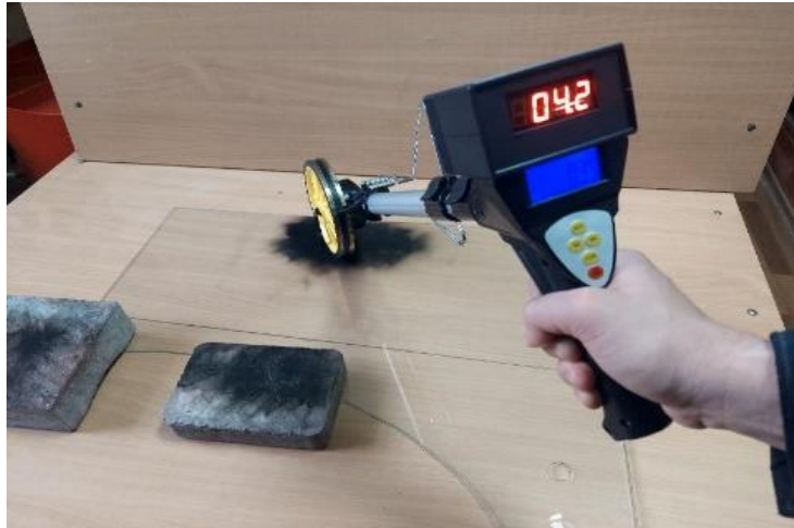
Рисунок 1 – Випробувальний зразок приладу для безперервного виявлення та фіксації осередкових ознак пожежі
