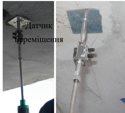
Рисунок 4 – Система збору даних (датчики тиску та переміщення) [15]
