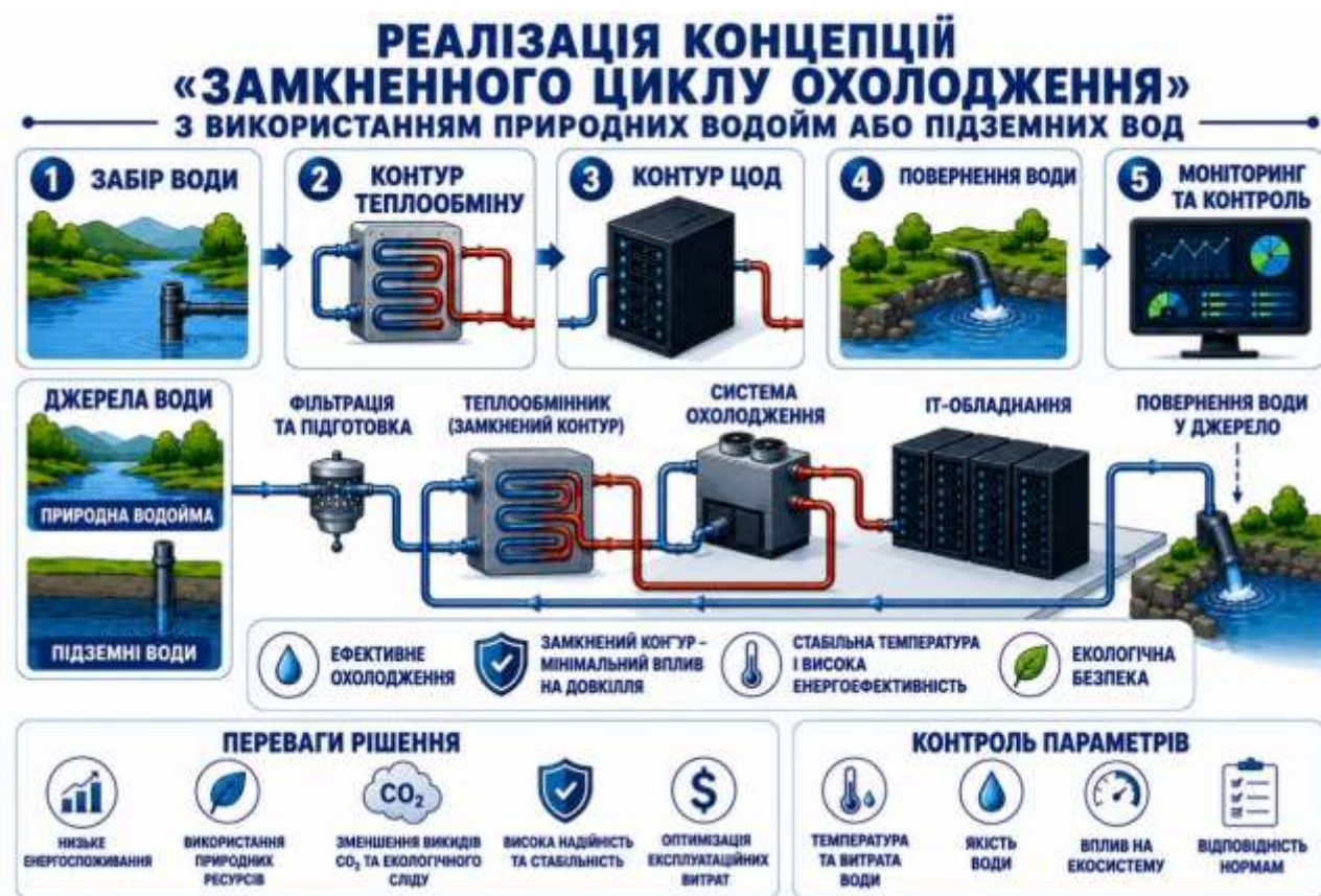
Рис. 2. Реалізація концепції «замкненого циклу охолодження» з використанням природних водойм або підземних вод
