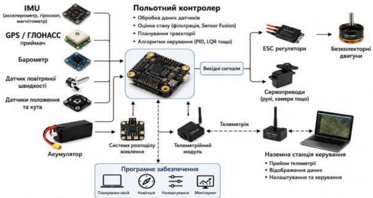
Рис. 2. Структурна схема системи автоматичного керування та навігації безпілотного літального апарата.
