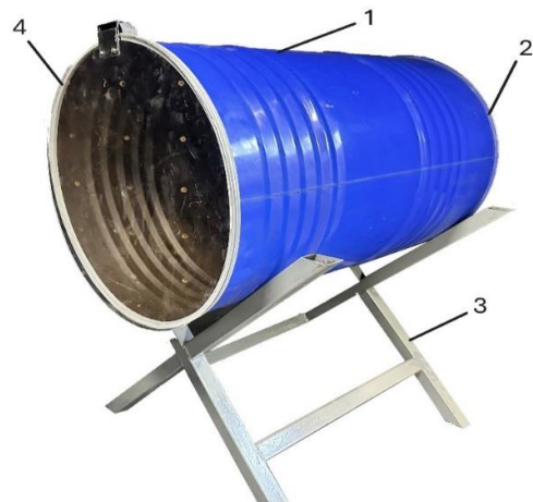
Рисунок 1 – Схематичне зображення та зовнішній вигляд ОВАЗЗП: 1 - випробувальна камера; 2 - отвір; 3 - підставка; 4 - дверцята
