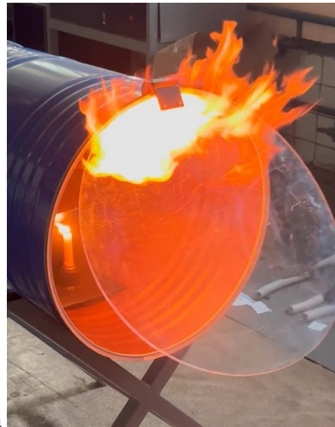
Рисунок 4 – Процедура випробування аерозольних розпилювачів: а - джерело запалювання на підставці (екрані) у випробувальній камері; б – займання вмісту аерозольного розпилювач
