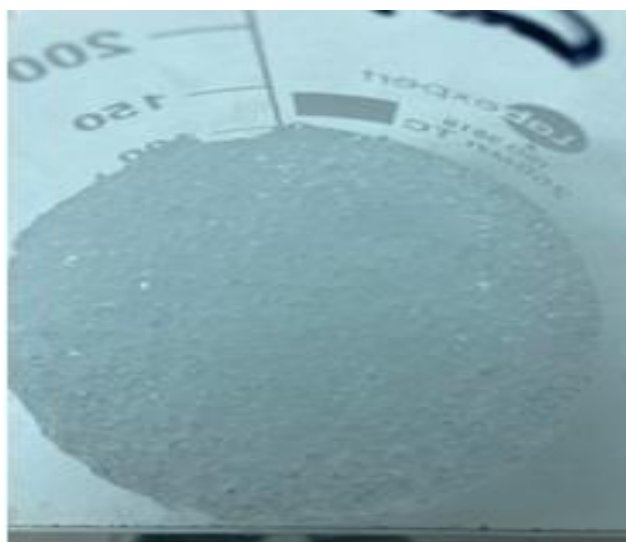
Рисунок 2.1 – Загальний вигляд високо поглинального нерозчинного полімеру ПА, розчиненого у воді
