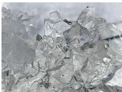
Рисунок 2.9 – Частки гелю, які піддалися процесу агрегатизації під час контакту з водою
