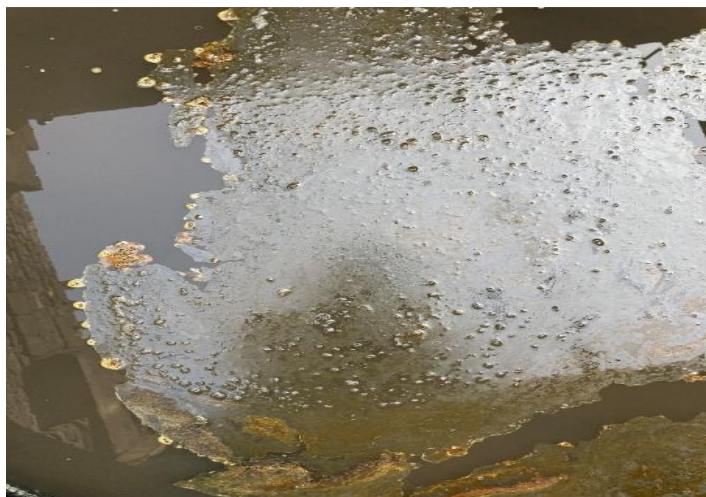
Рисунок 4.3 – Захисна гелева плівка, що утворилася підчас гасіння модельного вогнища 55В розчином на основі гелевого концентрату та піноутворювача загального призначення
