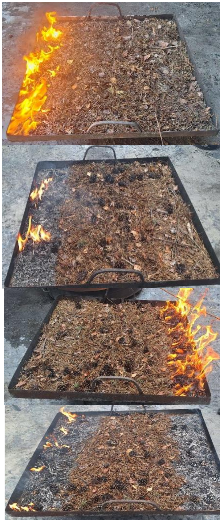
Рисунок 1 - Робочі моменти проведення досліджень з визначення ефективності створених вогнеперешкоджувальних смуг
