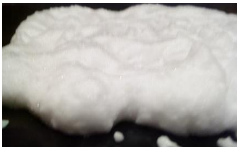
Рисунок 1.2 – Загальний вигляд піни низької кратності, отриманої під час механічного перемішування
