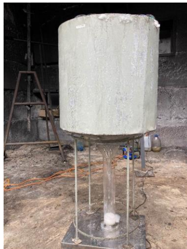
Рисунок 1 - Фото процесу визначення кратності та стійкості піни середньої кратності
