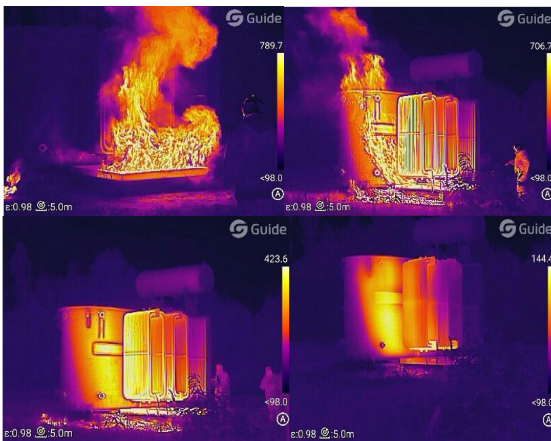
Рисунок 1 - Робочі моменти проведення досліджень з визначення вогнегасної здатності модифікованої водної вогнегасної речовини
