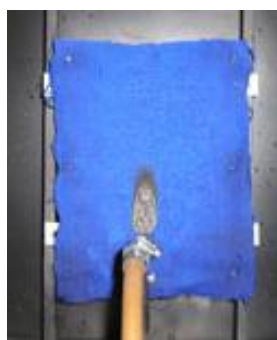
Рисунок 4 Зовнішній вигляд досліджуваних зразків вовни після випробувань 1 – необроблений зразок (час прогару 11 с); 2 – зразок, що занурювався у воду (час прогару 38 с); 3 – зразок оброблений ГУС (час прогару 1159 с).
