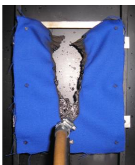
Рисунок 4 Зовнішній вигляд досліджуваних зразків вовни після випробувань 1 – необроблений зразок (час прогару 11 с); 2 – зразок, що занурювався у воду (час прогару 38 с); 3 – зразок оброблений ГУС (час прогару 1159 с).
