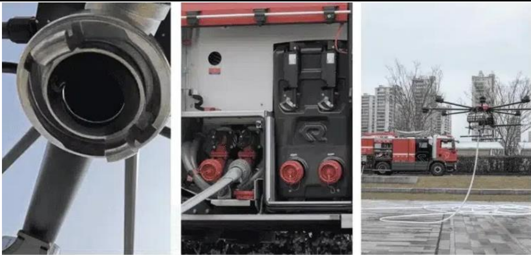
Рисунок 2 – Механізм швидкого з'єднання для безперешкодної інтеграції з пожежними автомобілями
