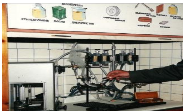
Рисунок – 1. Схема та фото лабораторної установки для визначення вогнегасної ефективності порошків при гасінні полум'я із змінною концентрацією кисню в газоповітряному середовищі: 1 – циліндричний пальник Бунзена; 2 – ежектор; 3 – ротаметри; 4 – регулювальні крани; 5 – лійка ежектора
