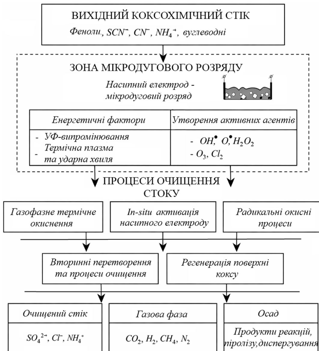
Рисунок 1 – Схема процесів під час мікродугового очищення стічних вод
