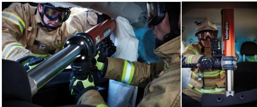
Рисунок 1 – Встановлення телескопічного домкрата для стабілізації конструкції автомобіля
