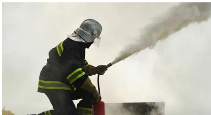
Рисунок 2 – Використання порошкового вогнегасника для утворення порошкової завіси
