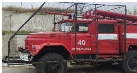
Рисунок – 1 Вигляд захисного сіткового контуру на пожежній автоцистерні
