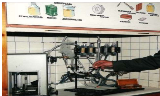
Рисунок – 1. Схема та фото лабораторної установки для визначення вогнегасної ефективності порошоків при гасінні полум'я із змінною концентрацією кисню в газоповітряному середовищі: 1 – циліндричний пальник Бунзена; 2 – ежектор; 3 – ротаметри; 4 – регулювальні крани; 5 – лійка ежектора
