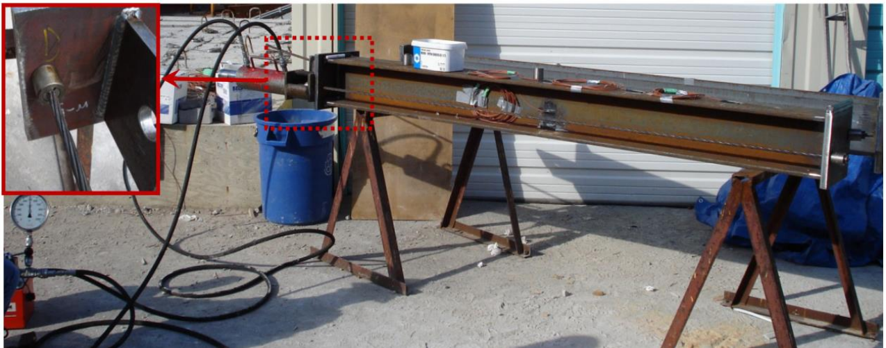
Рис. 2.16 – Система попереднього напруження для задавання осьового навантаження
