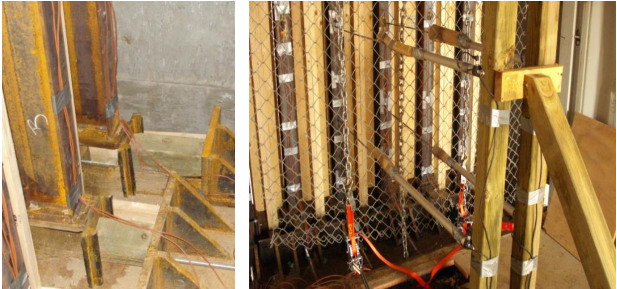
Рис. 2.19 – Система вимірювання деформацій та переміщень: а) тензодатчики; б) лінійні потенціометри
