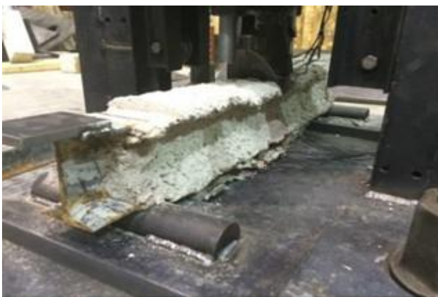
Рис. 2.11 – Загальний вигляд чисельної моделі та експериментального зразка: а) скінченно-елементна модель сталеві балки зі штукатурним вогнезахисним покриттям; б) експериментальний зразок в установці перед випробуванням
