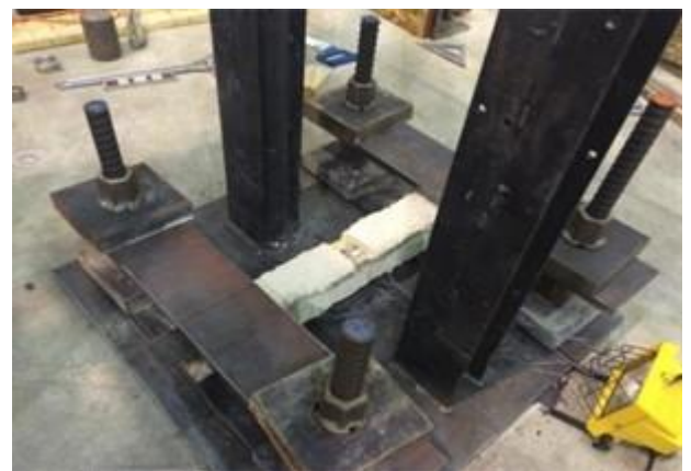
Рис. 2.11 – Загальний вигляд чисельної моделі та експериментального зразка: а) скінченно-елементна модель сталеві балки зі штукатурним вогнезахисним покриттям; б) експериментальний зразок в установці перед випробуванням
