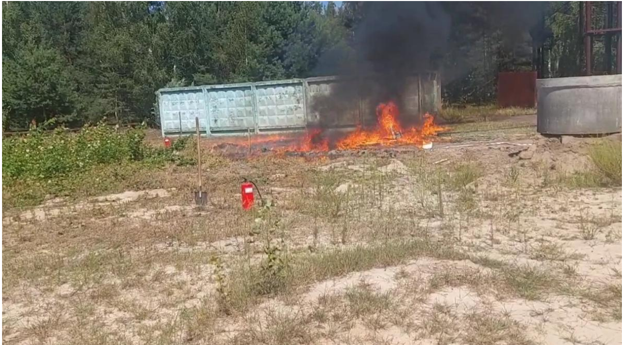
Рисунок 3.7 – Четвертий етап натурних досліджень. Відбувається друга фаза горіння та формування стабільного осередку пожежі.
