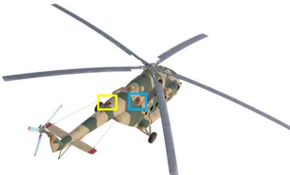
Рисунок 2 – Розташування забору (синій колір) та відведення (жовтий колір) повітря
