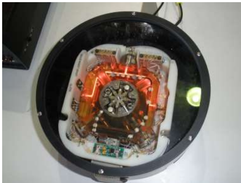
Рисунок 2 – Кільцевий лазерний гіроскоп. Резонатор має форму квадрата. У його центрі розташований вібропідвіс [4]
