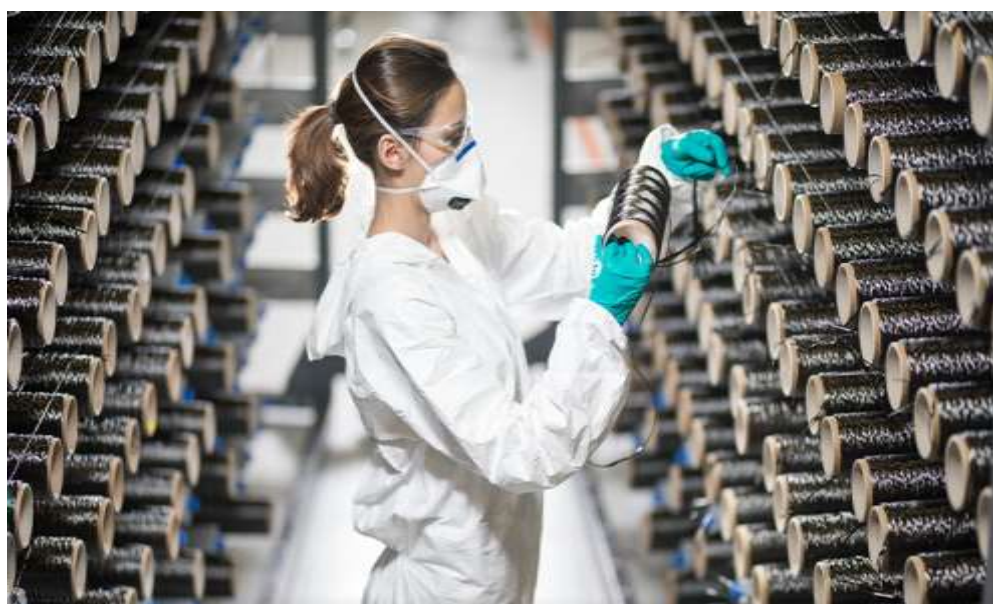
Рисунок 3 – Встановлення котушок вуглецевого волокна в ткацький верстат на заводі Safran Nacelles
