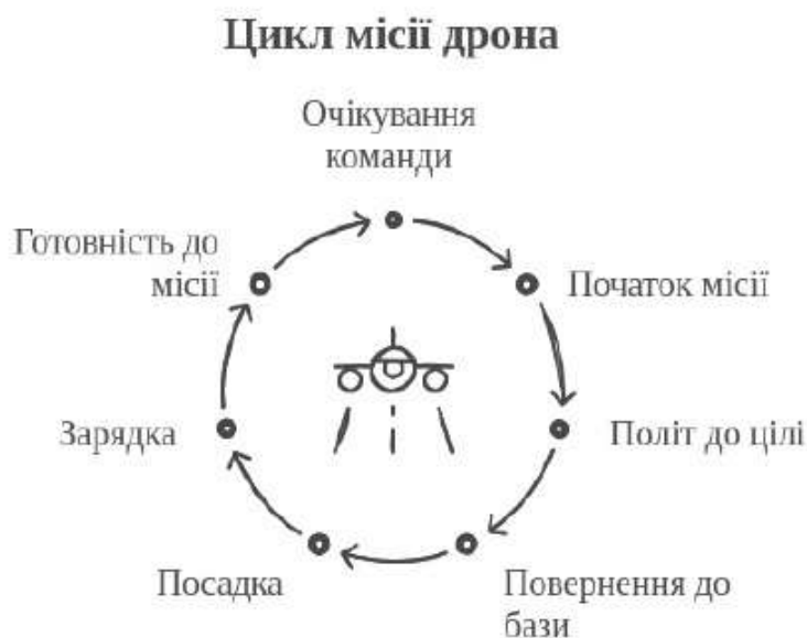
Рисунок 2 – Схематичний опис логіки відпрацювання місії польотного контролера ArduPilot
