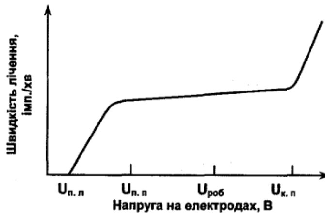
Рис. 3.6. Лічильна характеристика лічильника: U_{п.л.} - напруга початку лічення; U_{п.п.} - напруга на початку плато; U_{роб} - робоча напруга; U_{к.п.} - напруга в кінці плато.
