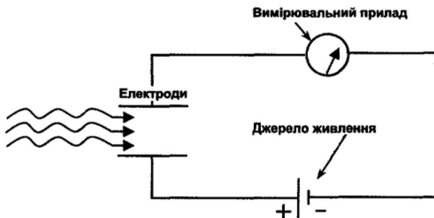
Рис. 3.1. Найпростіша схема іонізаційного детектора
