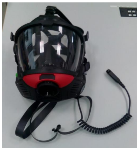
Рисунок 2.33 – Панорамна маска Dräger FPS 7000 з радіо та гучномовним зв'язком
