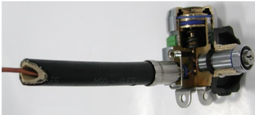
Рисунок 2.60 – Редуктор апаратів серії BD 96
