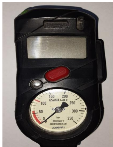
Рисунок 2.61 – Контрольний прилад ISU
