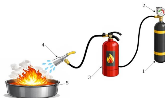
Рисунок 1 – Схема установки для проведення вогнегасних випробувань ВВР:
