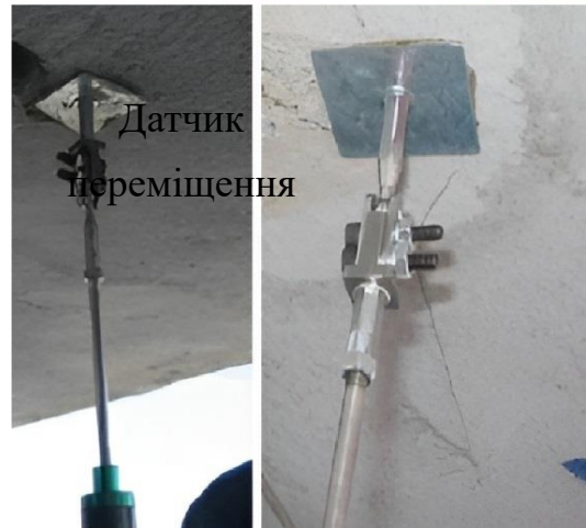
Рисунок 4 – Система збору даних (датчики тиску та переміщення) [15]
