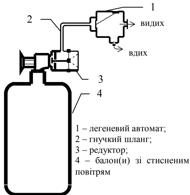
Рисунок 3.6 – Принципова схема резервуарного дихального апарата
