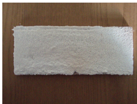
Рис. 2 б. Зразок деревини, який оброблено ксерогелем при додаванні в розчин Na_2O \cdot 2,95SiO_2 азбесту 40 \text{ г} \cdot \text{л}^{-1}
