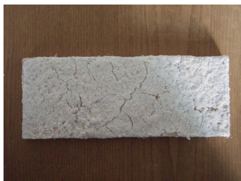
Рис. 2 а. Зразок деревини, який оброблено ксерогелем ГУС Na_2O \cdot 2,95SiO_2 - CaCl_2
