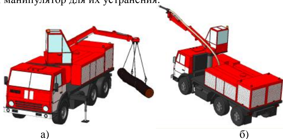
Рис. 2. Режим работы АЛЧС с использованием манипулятора для устранения препятствий (а) и тушения пожара (б)
