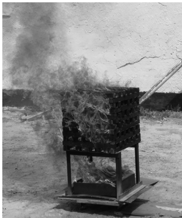
Рис. 2 – Горіння стандартизованого модельного вогнища
