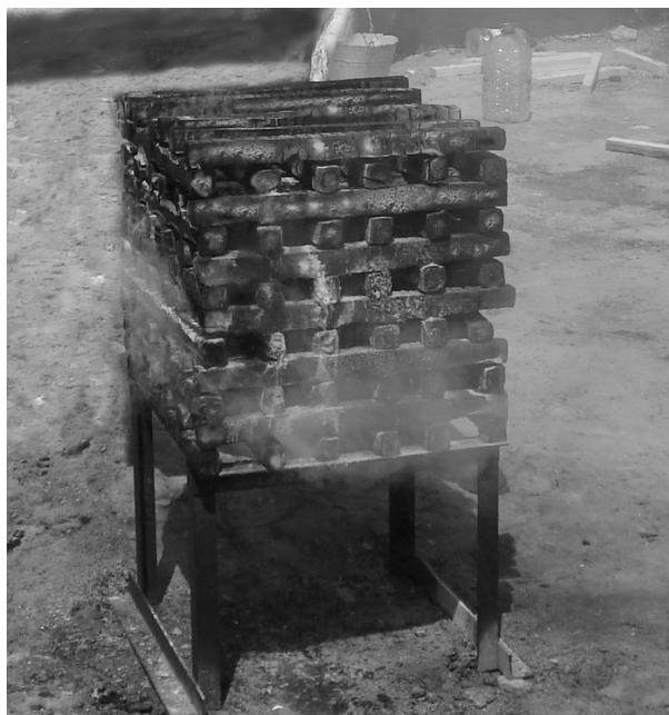
Рис. 4 – Стандартизоване модельне вогнище після гасіння ГУС \text{CaCl}_2 11,4% – \text{Na}_2\text{O} \cdot 2,95\text{SiO}_2 3,8% – \text{H}_2\text{O} 84,8%
