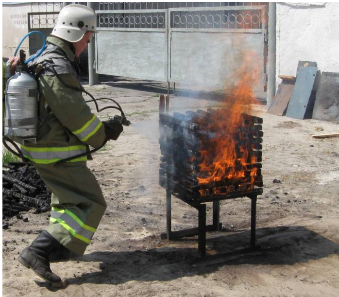
Рис. 3 – Гасіння стандартизованого модельного вогнища
