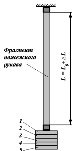
Рисунок 1 – Опытная установка с установленным фрагментом пожарного рукава. Начальная длина фрагмента пожарного рукава L_0 = 2,270 м.
