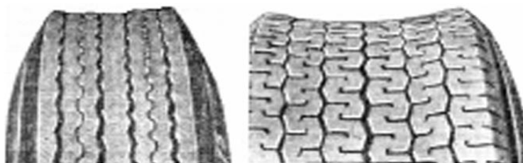
Рисунок 1 – Шини з ребристим дорожнім рисунком, які мають зворотну кривизну протектора
