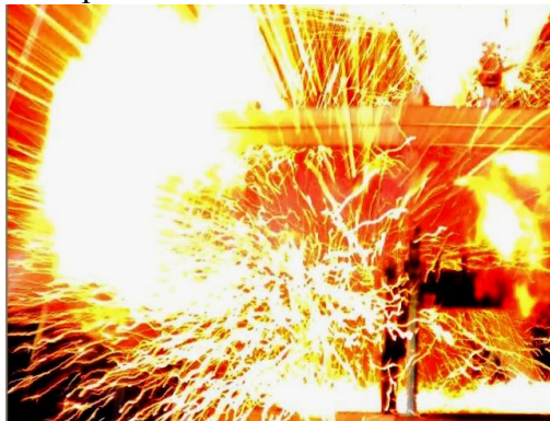
Рис. 2. Начальная стадия ЭВ медной жилы сечением S_1 \approx 3,2 \text{ мм}^2 ОО радиочастотного коаксиального кабеля марки РК 50-7-11 со сплошной ПЭТ изоляцией длиной 0,5 м в сильноточной разрядной цепи генератора типа ГИТМ-10/350
