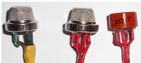
Рисунок 1 – Внешний вид газовых датчиков типа MQ-4, MQ-6, MQ-7
