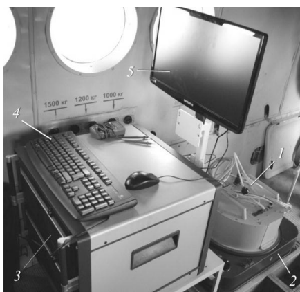
Рисунок 2. Система АВИС, установленная на борту самолета АН-2:
