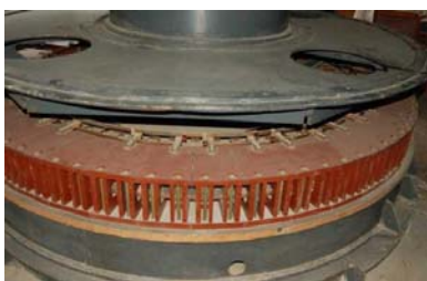
Рис. 1. Конструкція електричного моментного двигуна
