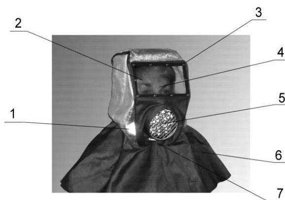
Рисунок 3. Саморятівник термозахисний термокомпенсуючий «Супровідник» 1 – вогнестійкий шолом; 2 – ілюмінатор; 3 – підшоломник з термокомпенсаторами та гумовою півмаскою 4; 5 – фільтруюче-сорбуючий елемент (ТУ У 28.2-01530125-030:2012); 6 – пелерина; 7– шийний обтюратор
