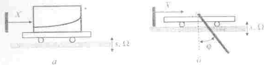
Рис. 1. Експеримент із хвилями Фарадея в рухомій смісності (а); іхній механічний аналог – маятник під візком (б)
