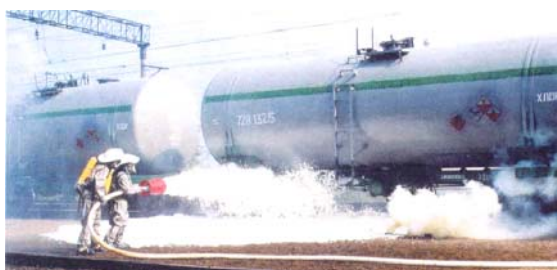
Рис. 7 – Накриття шаром піни місця розливання НХР
