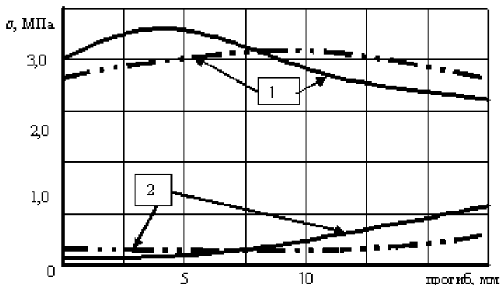
Рисунок 3 – Напряжения на поверхности шины в зоне борта для шины 205/70R14 (1 – наружная поверхность; 2 – внутренняя поверхность; пунктиром – 175/70R13)
