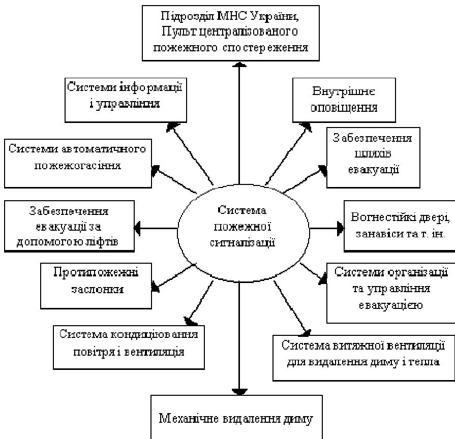
Рис. 12.4 – Схема сигналізації-інформації-керування в системі пожежної безпеки
