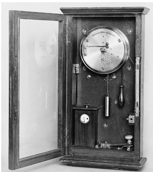
Рис. 1 – Прилад електричної пожежної сигналізації виробництва компанії „Siemens & Halske” (фото 1851 р.)
