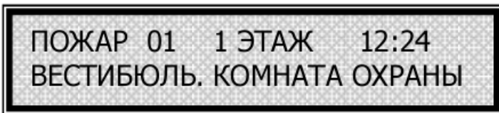
Рис. 8.9 – Індикація інформації про пожежі на дисплеї приладу ПУ–П
