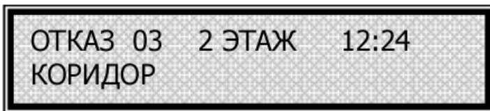
Рис. 8.10 Індикація інформації про відмову на дисплеї приладу ПУ–П
