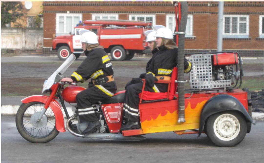
Розміщення пожежного розрахунку на пожежному мотоциклі
