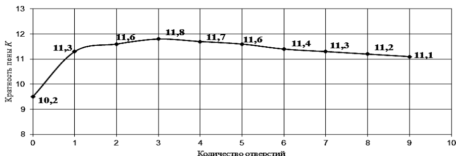
Рис. 1. Зависимость кратности воздушно-механической пены, генерируемой водопенным насадком, от количества отверстий для предварительного газонасыщения
