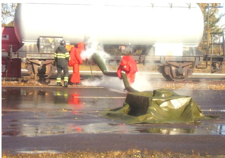
Рисунок 1 - Локализация аварии с выходом сжиженного газа с использованием способа повторной конденсации
