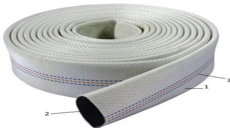
Рисунок 1. Прорезиненный напорный пожарный рукав: 1 - однослойная ткань полотняного переплетения; 2 - резина; 3 - прословка
