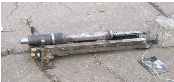
Рисунок 1 – Экспериментальный образец водяной системы пожаротушения импульсного действия
