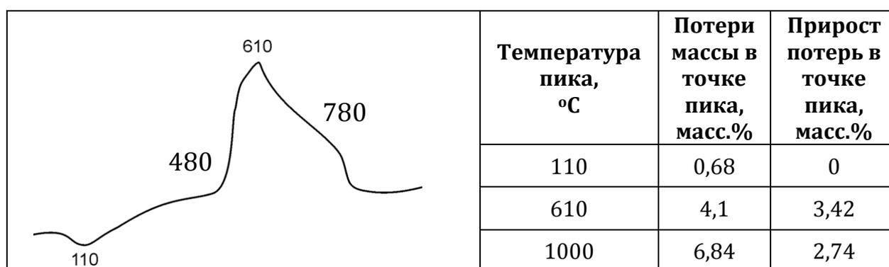
**Рис.4.1 – Обработка данных дифференциально-термического анализа экспериментального покрытия**
