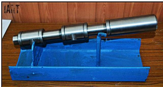
Рисунок 6 - Устройство гидроимпульсного разрушения элементов строительных конструкций
