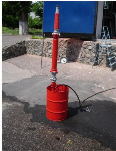
Рисунок 1 - Гидроударный генератор импульсов сверхвысокого давления
