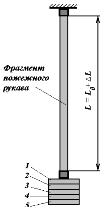
Рис. 1 – Дослідна установка із встановленим фрагментом пожежного рукава з початковою довжиною L_0=2,190 м
