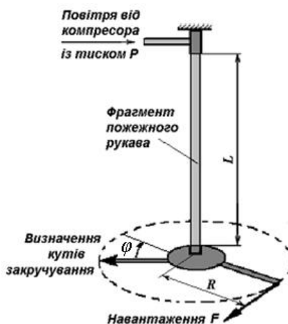
Рисунок 1 – Дослідна установка із встановленим фрагментом пожежного рукава
