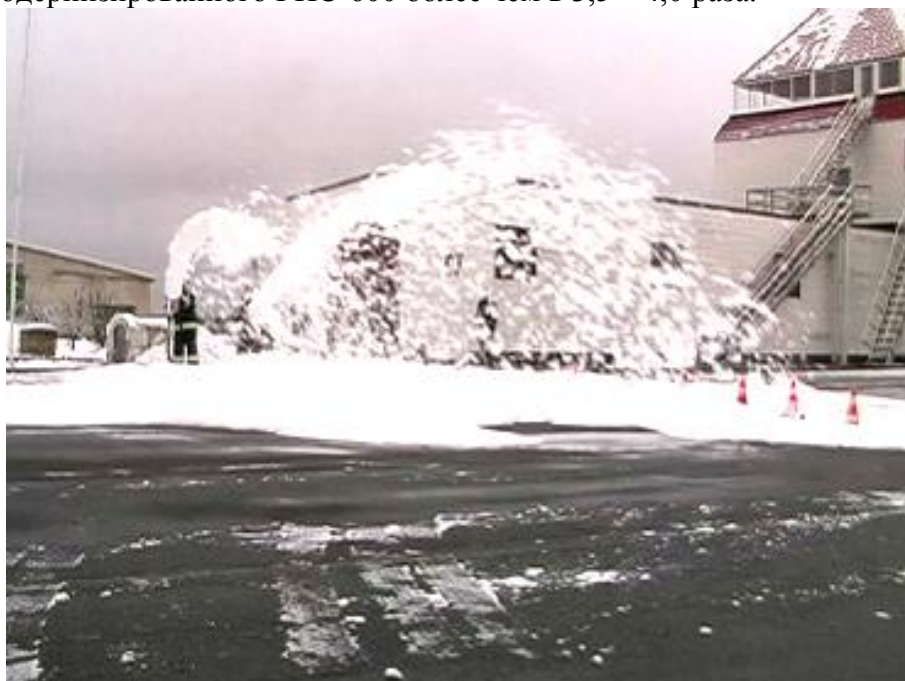
Рисунок 4 –Подача пены вторым образцом по сравнению с серийным ГПС-600
