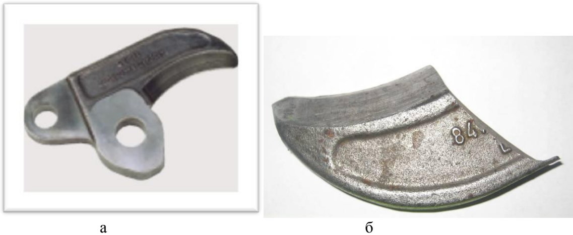
а б Рисунок 2 - Режущий элемент резака фирмы Lucas а – новый элемент; б - облом режущего элемента резака
