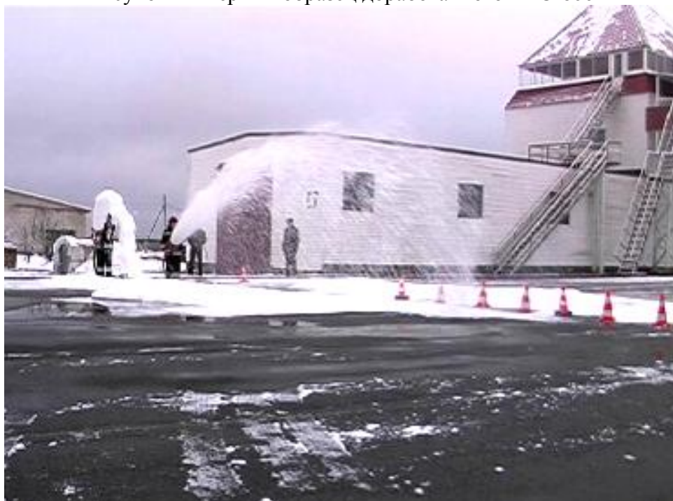
Рисунок 2 –Подача пены первым образцом по сравнению с серийным ГПС-600
