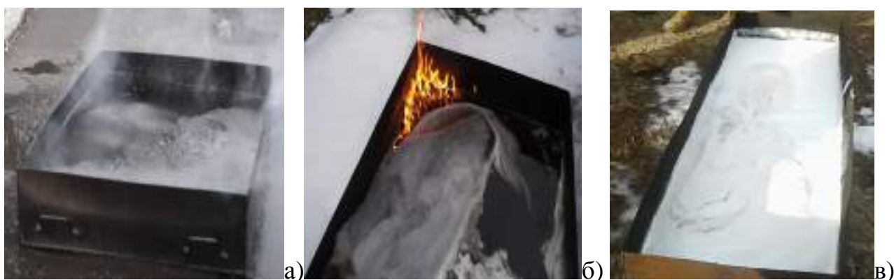
Рис. 1. Гасіння прямокутних дек з використанням Барс АFFF-1: а) загашене деко з нафтопродуктом вкрите плівкою утвореною БАРС АFFF-1, з використанням ствола СВП; б) вогонь відступає від розтікання плівки Барс; в) загашене деко вкрите піною отриманою із АFFF-1 за допомогою ствола ГПС-50
